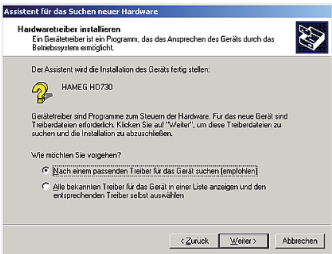
7.2.2 „Nach einem passenden Treiber für das Gerät suchen (empfohlen)“ wählen und klicken Sie anschließend auf „Weiter“.
